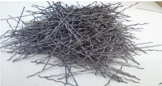
Fig. 4 - Steel Fibres
